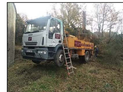
Fotografia 1. Detall de la màquina utilitzada per a la realització del sondeig a rotació realitzat.
